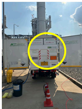
ภาพที่ 2-28 การติดเครื่องหมาย ป้ายวัตถุอันตราย และเบอร์โทรศัพท์ที่ตัวถังของรถบรรทุกสารเคมี
