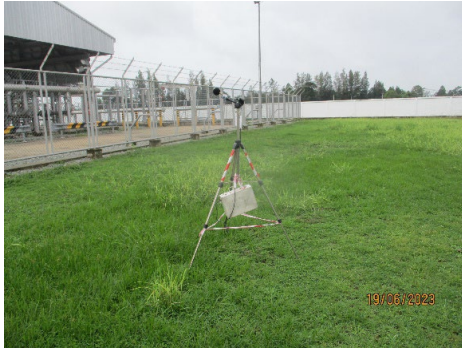
ภาพที่ 2-7 การตรวจวัดระดับเสียงบริเวณริมรั้วโรงไฟฟ้า
