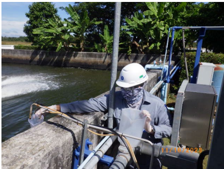
ภาพที่ 2-11 การตรวจวัดคุณภาพน้ำทิ้งแบบครั้งคราว บริเวณจุดระบายน้ำทิ้งของโครงการ
